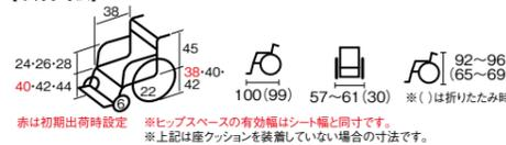
■介助式 ●シート幅/40.42.44cm ●耐荷重/100kg
